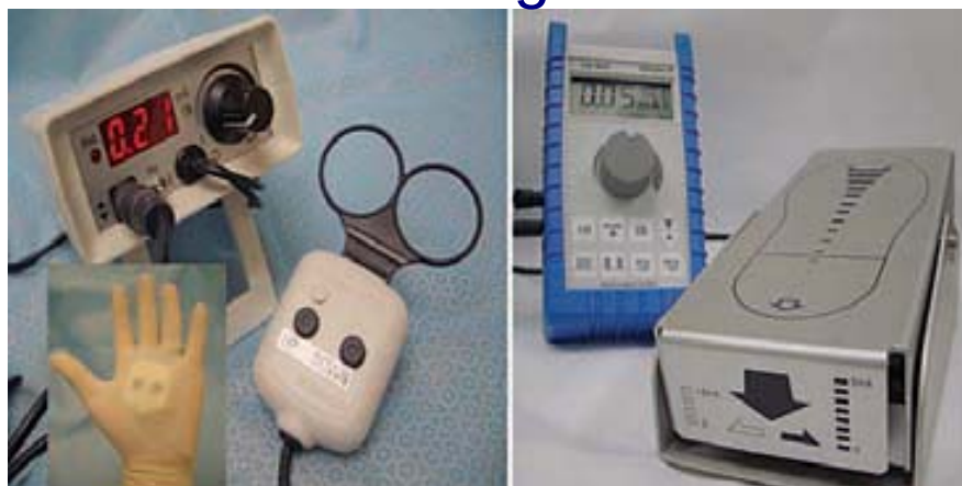
Figura 17-12. Ejemplos de controladores remotos. (Izquierda) Controlador manual. (Derecha) Controlador de pedal.
